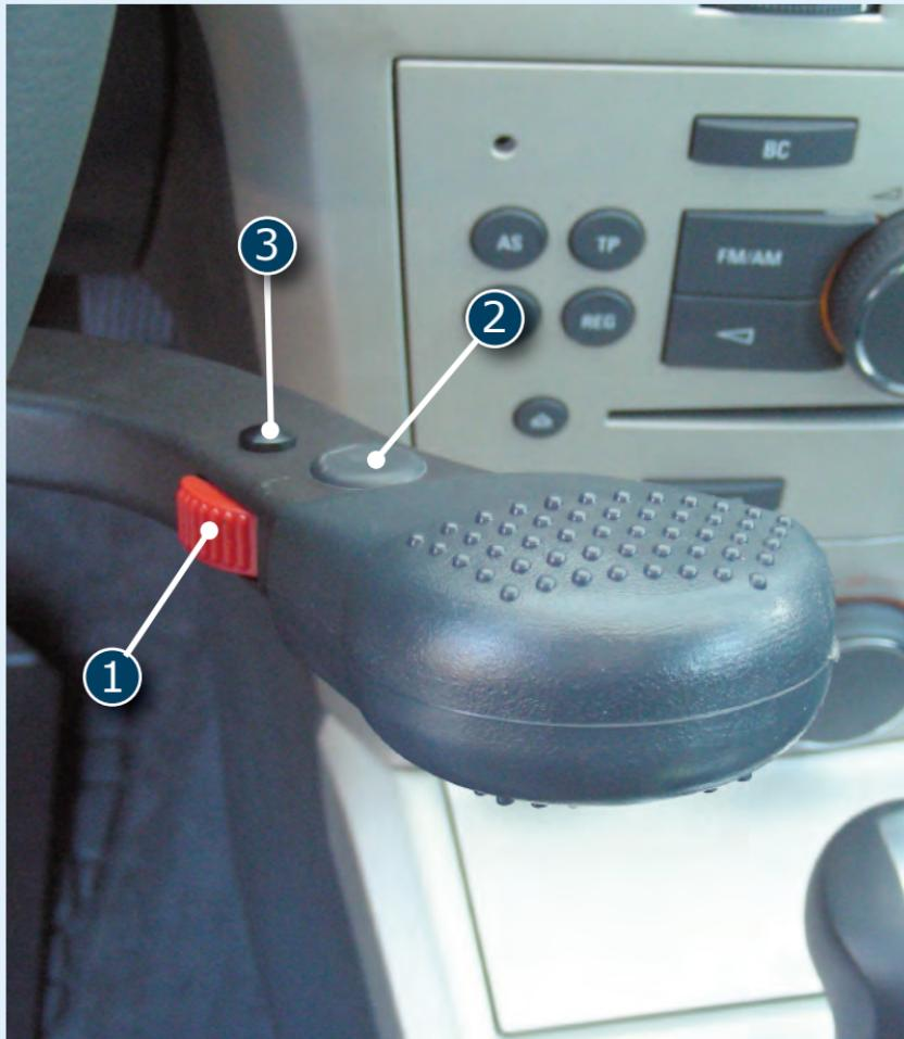
**1** Bloccaggio della leva freno
