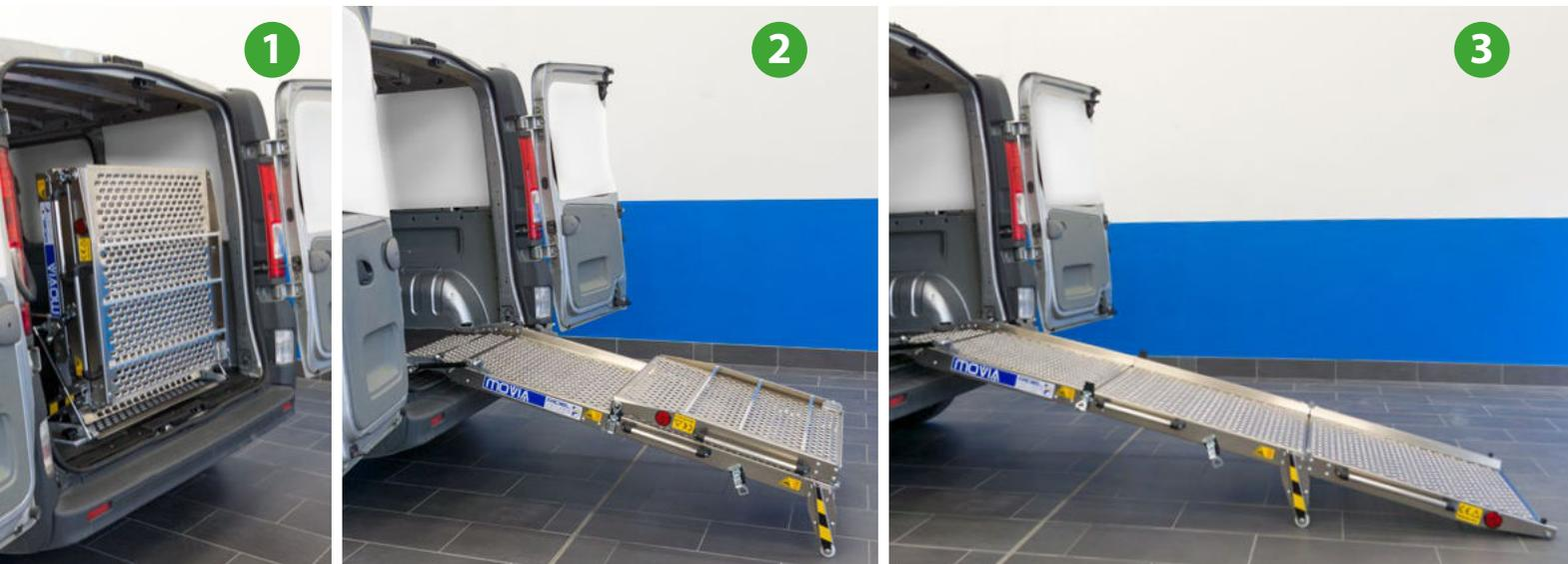
La Rampa MOVIA es un dispositivo de transporte que facilita el acceso de personas con discapacidad al vehículo. También puede ser utilizada para la manipulación de otros medios y equipos como carritos para servicios de catering, hospitalarios, servicios de audio/luz y máquinas expendedoras automáticas.
